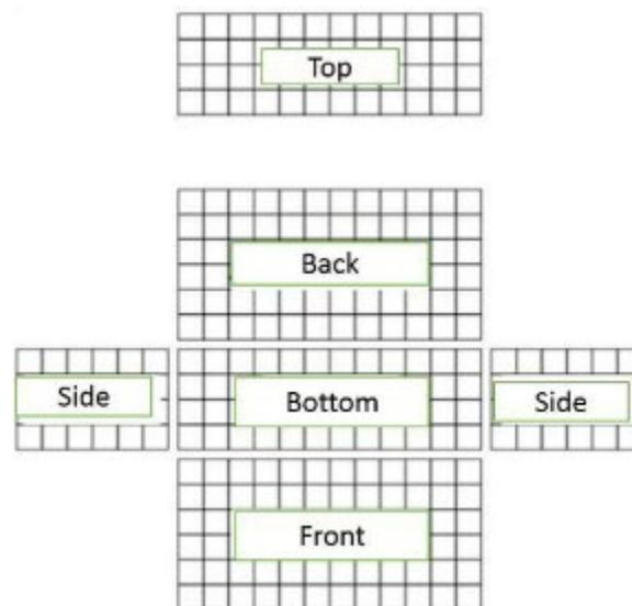
2. Fügen Sie die 5 Basisplatten (nicht die obere Platte) mithilfe der Verbindungsclips zusammen, die in einem Beutel mit 30 Clips verkauft werden. Die Verbindungsclips werden wie folgt zusammengesetzt:
